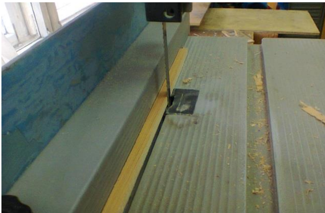
Изготовление рейки на ленточной пиле.
